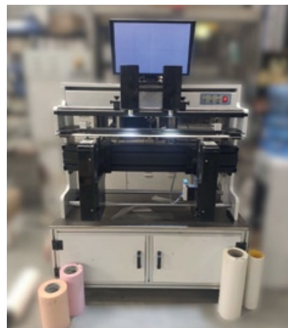
VS-TBJ600 — устройство с видеокамерами для полуавтоматического монтажа флексоформ на формный цилиндр
