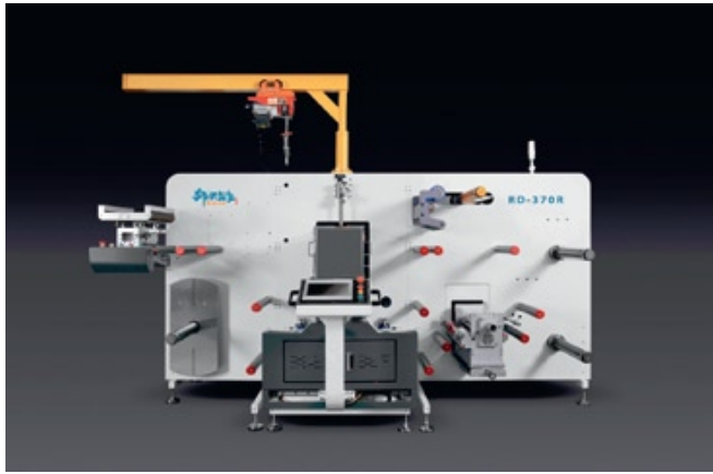
Рис. 1. Vision RDF 330 в описанной минимальной конфигурации с добавлением крана для для упрощения замены магнитных цилиндров
