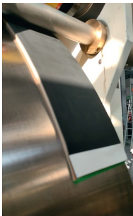
Рис. 6. На фото слева — офсетное полотно; на фото справа — формный цилиндр с формой, чуть ниже — офсетное полотно
