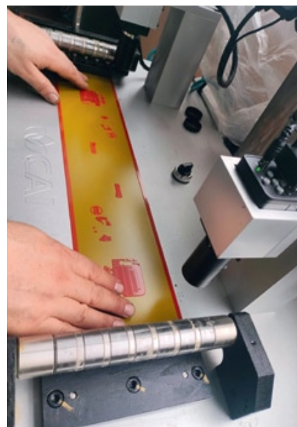
Рис. 3. Слева — монтажный станок для прокола форм; справа — процесс прокола формы по техническим меткам
