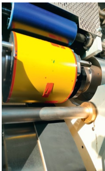
Рис. 6. На фото слева — офсетное полотно; на фото справа — формный цилиндр с формой, чуть ниже — офсетное полотно
