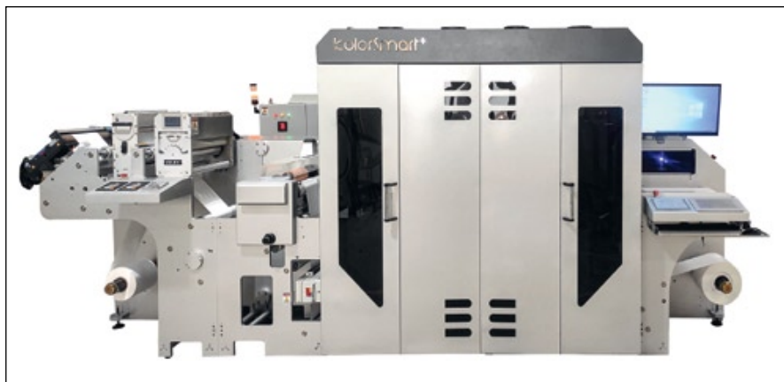
Цифровая печатная машина JETSCI KolorSmart+ от Monotech Systems
