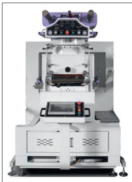
Рис. 5. Секция плоского горячего тиснения с усилием 50 т с возможностью поворота на 90°
