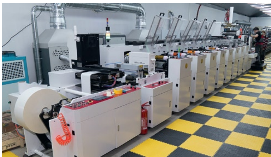
Новая узкорулонная флексографская машина DongHang DHF20350-8. Максимальная ширина материала 370 мм, скорость печати до 180 м/мин
